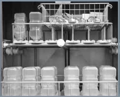
Armarios compactos para el lavado y/o secado de biberones, bidones y otros utensilios como cubos, ollas...
