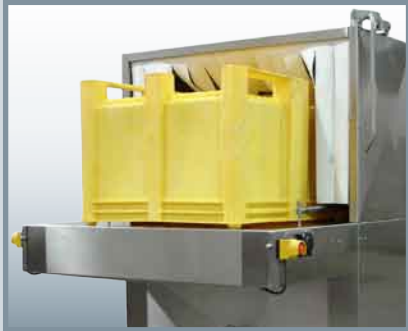
Túneles compactos para producciones de gran potencia para lavado de contenedores “palots”, adaptables a lavado de cajas
