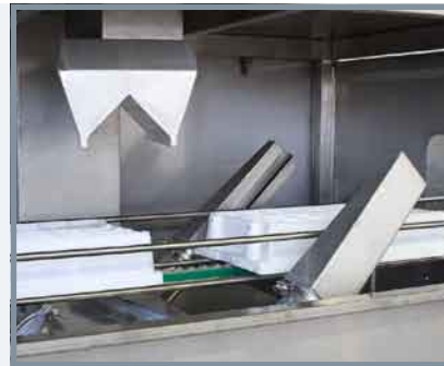
Túneles modulares de soplado y/o secado de cajas, bandejas, palets, contenedores "palots"... acoplables a los túneles de lavado
