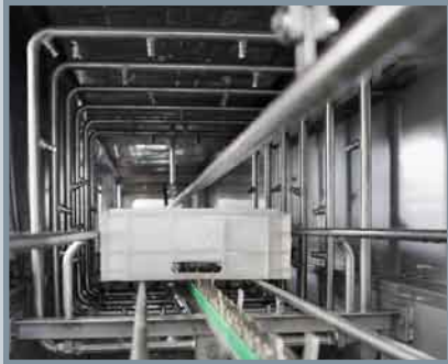
Túneles modulares para producciones medias y grandes de lavado cajas, bandejas, palets, contenedores "palots", moldes y piezas varias
