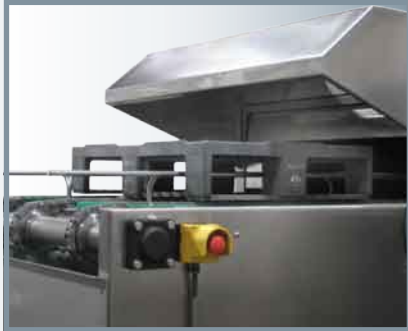
Túneles modulares para producciones medias y grandes de lavado cajas, bandejas, palets, contenedores "palots", moldes y piezas varias
