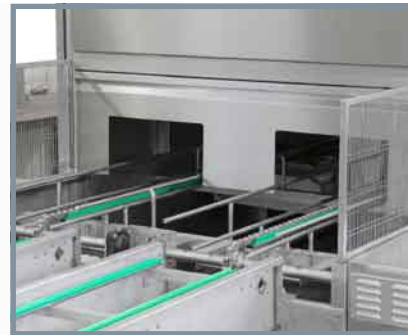
Túneles modulares de soplado y/o secado de cajas, bandejas, palets, contenedores "palots"... acoplables a los túneles de lavado
