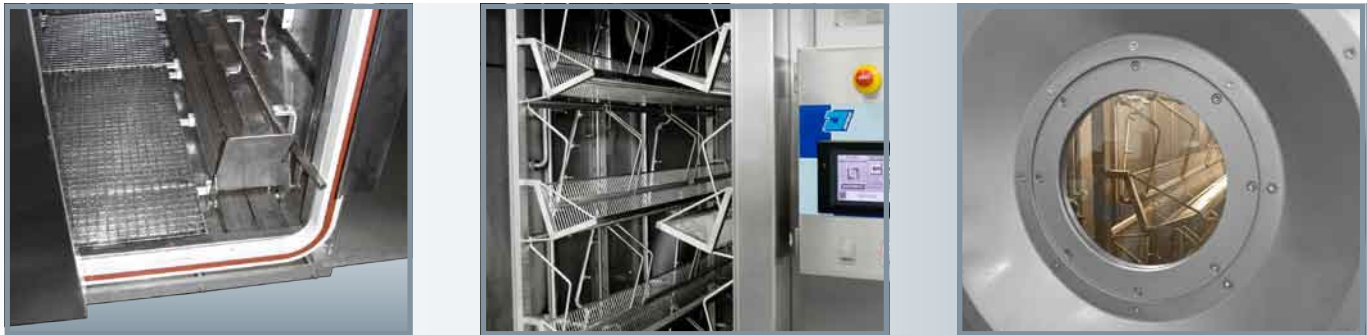
Armario compacto de grandes prestaciones para lavado de carros-soportes y racks-jaulas
